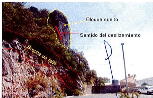
Figura 4: Bloque en peligro de deslizamiento
