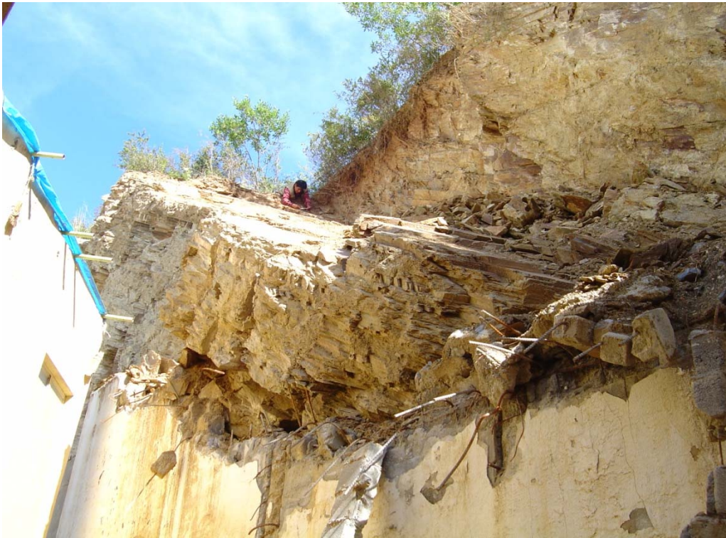
Fotografía 7.7b. Toma de datos estructurales para determinar la descomposición de las fuerzas del bloque.
