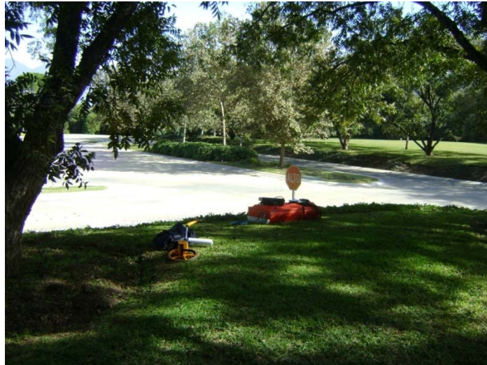
Fotografía 7.8.1.5.1a. Equipo de georadar SIR 3000 con su antena de 100 Mhz y odómetro.
