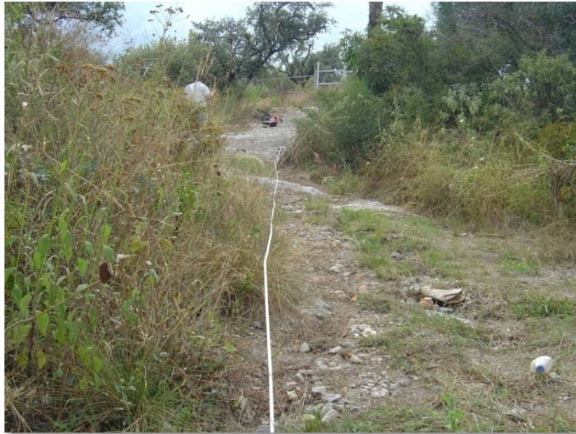
Fotografía 7.1. Tendido correspondiente a la línea de georadar No.1.
