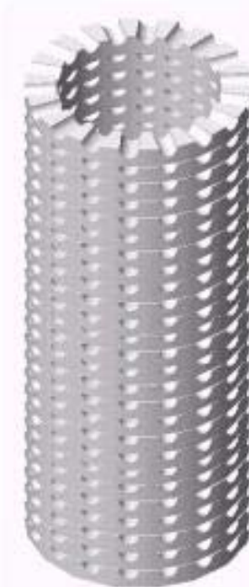
Figura 7.8.2.4. Diseño de construcción de pozos de absorción en el área del lago en el Corporativo CEMEX.
