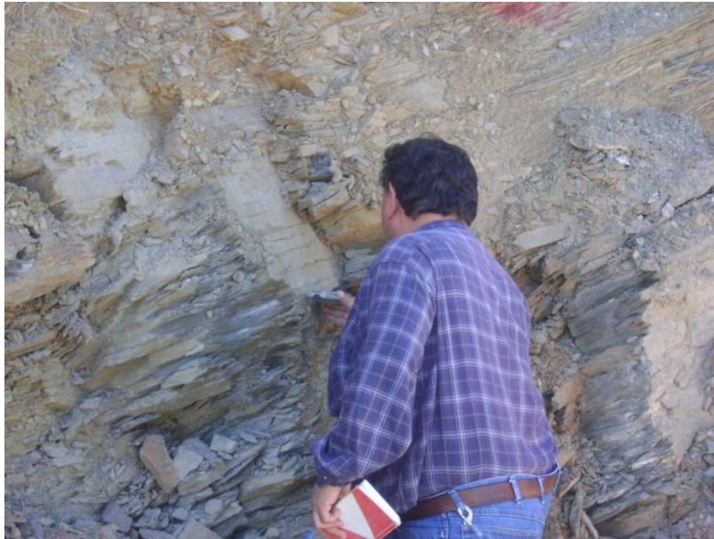
Fotografía 7.5.4. En la fotografía se muestra personal de este departamento en la toma de datos (echados, rumbos, grado de fracturamiento, rumbo de las fracturas, etc.)
